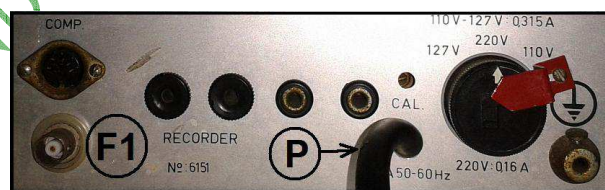
Rys. 2. Panel tylni konduktometru OK-102/1.
